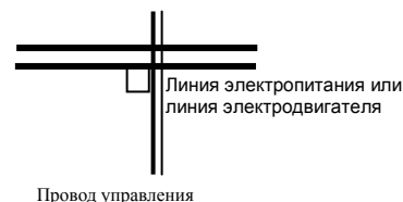
Рис. 3-14 Требования к прокладке проводов
